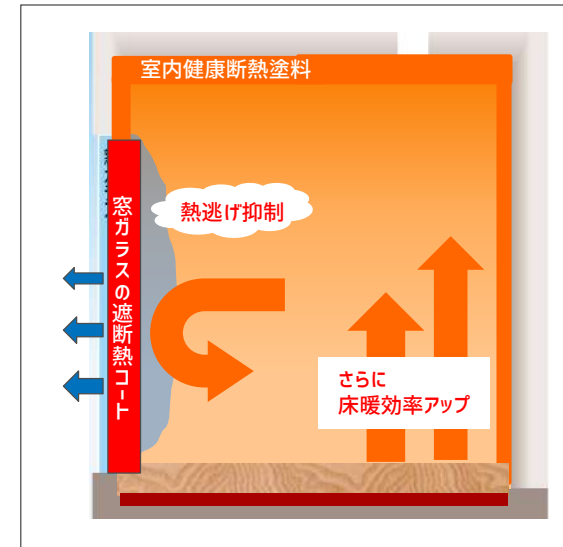
<さらに 室内健康断熱塗料を塗装>
